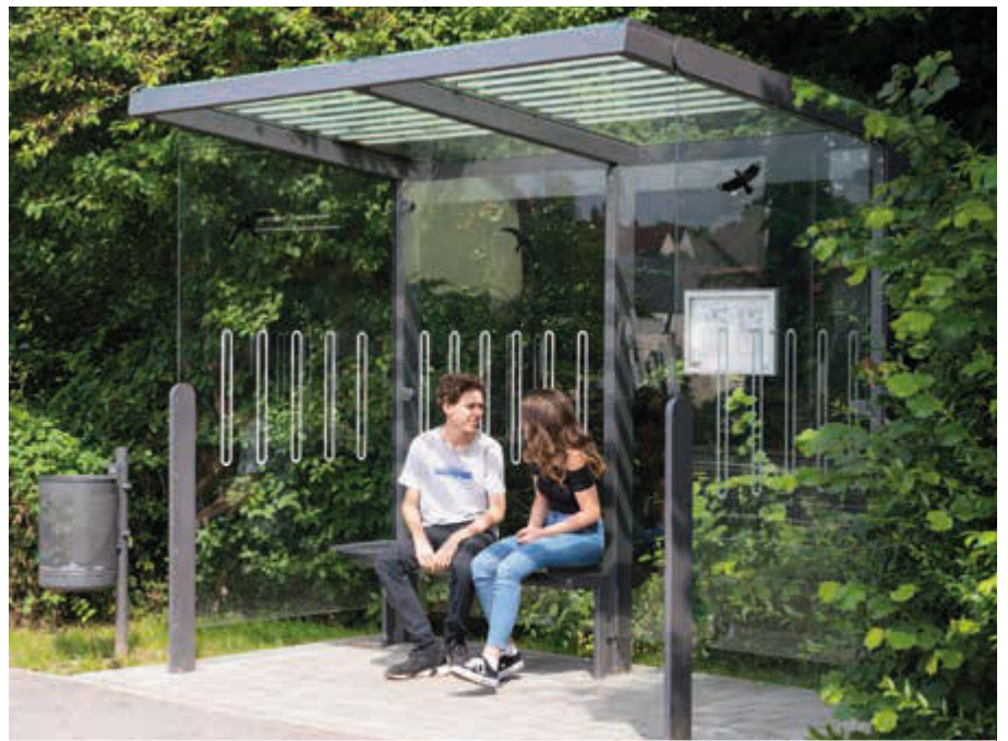
Wartehalle AUREO mit Pultdach, Dachbreite x Dachtiefe 2860 mm x 1855 mm, Seiten- und Rückwände ESG Klarglas mit Scheibendekor, auftragsbezogene Anpassung inklusive Schaukasten und Sitzbank, Stahlkonstruktion in DB 703 eisenglimmer
