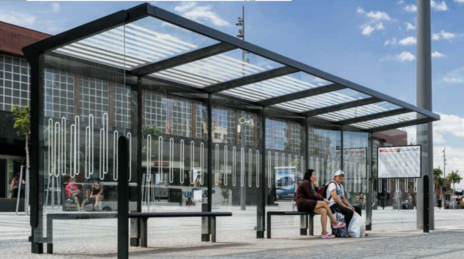
Wartehalle AUREO mit Pultdach, auftragsbezogene Anpassung, Dachbreite x Dachtiefe 8350 mm x 1855 mm, Seiten- und Rückwände ESG Klarglas mit Scheibendekor, inkl. Schaukasten und Sitzbänke, Stahlkonstruktion in RAL 7016 anthrazitgrau
