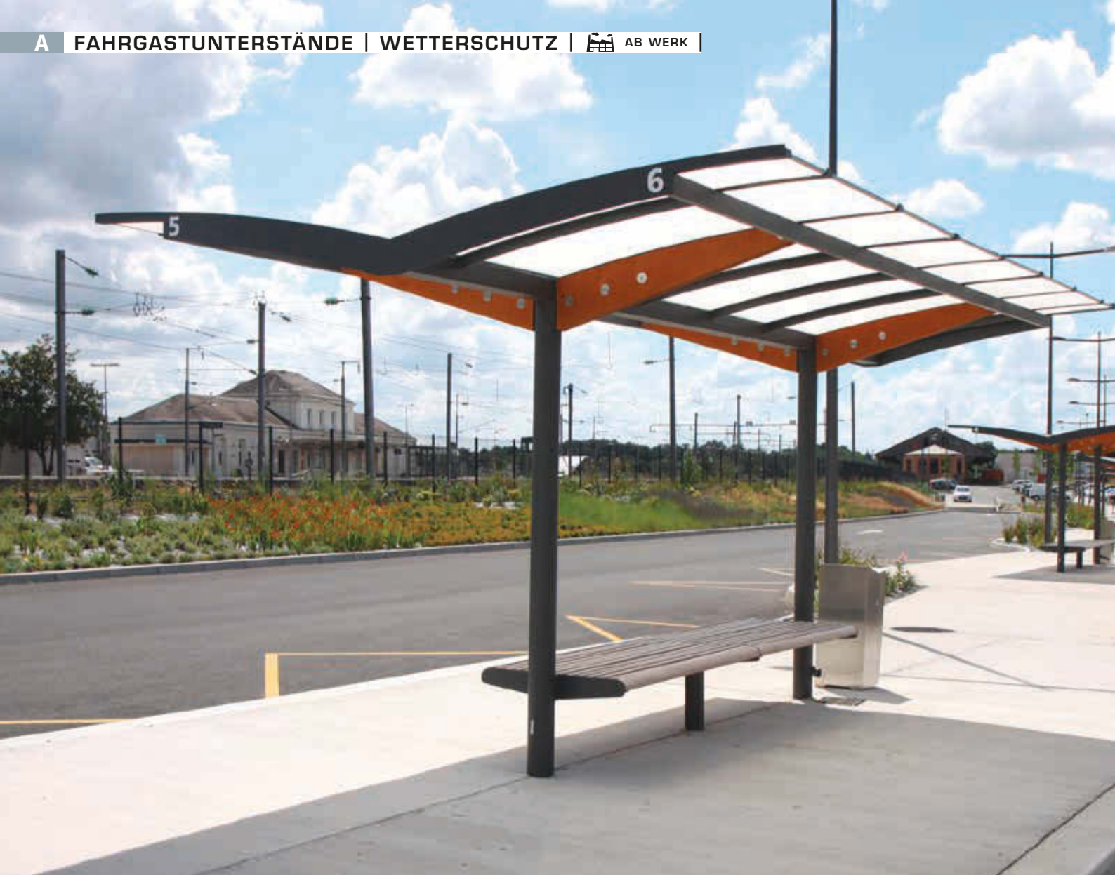
Wartehalle REGIO mit Bogendach, Dachbreite x Dachtiefe 5620 mm x 3560 mm, Dacheindeckung Polycarbonat, opal transparent, Sitzbank mittig, Stahlkonstruktion in RAL 7016 anthrazitgrau
