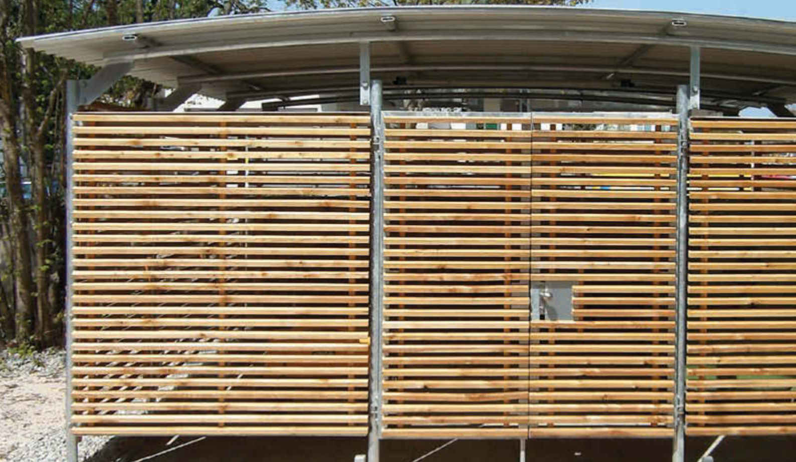
Wertstoffüberdachung BWA bausystem®, Dachbreite x Dachtiefe 4600 mm x 5600 mm, Stahlkonstruktion feuerverzinkt, Seitenwände und Doppelflügeltür (auftragsbezogene Anpassung) aus Lärchenholz
