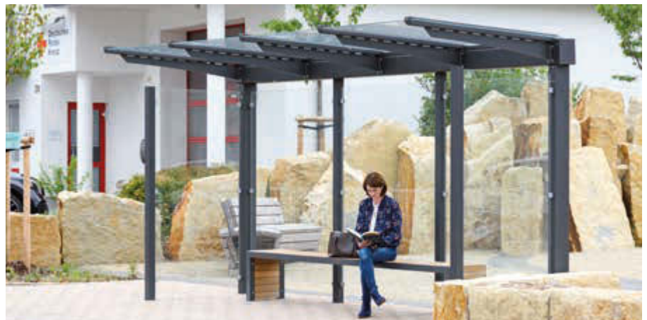
Wartehalle VIRGO, einseitig, Dachbreite x Dachtiefe 4720 mm x 1800 mm, Rück- und Seitenwände ESG Klarglas, Sitzbank bauseitig, Stahlkonstruktion in DB 703 eisenglimmer
